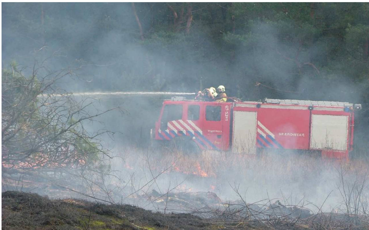
Afbeelding 17: Inzet van een terreinvaardige tankautospuiter tijdens een natuurbrand
